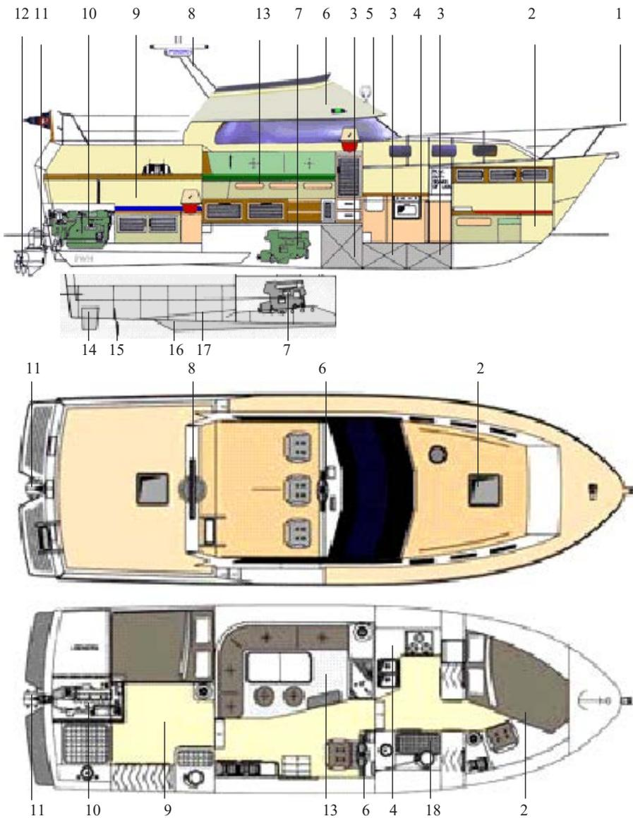
Рис.2. Продольный разрез и планы палуб круизного катера. 1. Якорное устройство. 2. Носовая каюта. 3. Цистерна. 4.Камбуз. 5.Фара. 6. Пост управления. 7. Центральный моторный отсек. 8.Радар. 9. Кормовая каюта. 10.Кормовой моторный отсек. 11.Колонка. 12.Транцевая площадка. 13.Салон. 14.Руль. 15.Винт. 16.Киль. 17. Вал. 18. Санузел.
